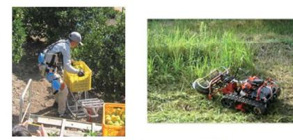
収穫物の積み下ろしなどの重労働をアシストスーツで軽労働するほか、除草ロボットなどにより作業を自動化
